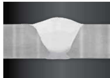
IAC-grondlaag verticaal neergaand gelast in koolstofstaal van 10 mm; gevuld met twee verticaal neergaand gelaste Sequence Repeat-lagen.
