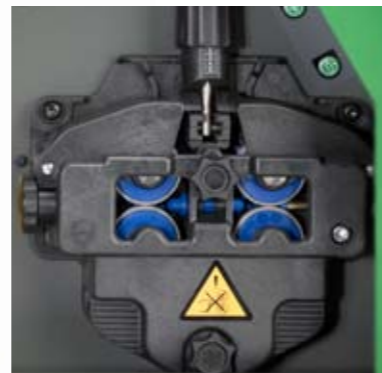
Vierrols draadtoevoersysteem met kleurcodering van de draadtransportrollen
