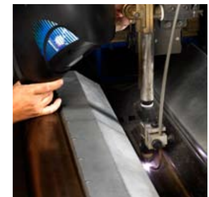
Plasma lassen van roestvast staal in een automatisch langsnaadsysteem
