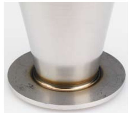
Plasma-drukglas van konische pijp op plaat. Zie de kleine A-hoogte
