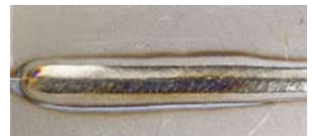
Plasma-keyholelas van 6 mm roestvast staal
