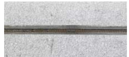
Plasma-smeltlas van 0,5 mm gegalvaniseerd koolstofstaal
