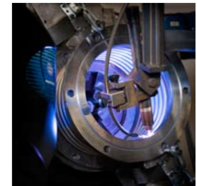
Lassen van roestvast staal - vibratie demper van uitlaat gassysteem
